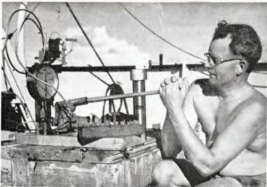
Professor Zo Bell med sit højtryksapparat, hvori han kan udsætte bakterierne fra de store dyb for et tryk, lige så stort som det, de kommer fra. Bakterierne holdes indeni en meget stærk stålcylander, som den, der ses midt i billedet
