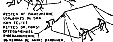
RESTEN AF BARDUNERNE UDPLØKKES OG SÅ KAN TELTET RETTES OP, FØRST EFTERSPÆNDES ENDEBARDUNERNE OG DERPÅ DE ANDRE BARDUNER, SÅ LUKKES TELTDØREN OG DER GØRES TELTDØREN HØRDER, VI KAN MELDE: KLAR.
