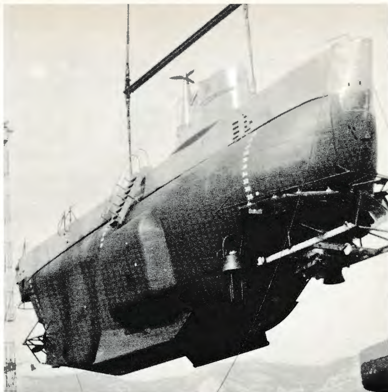
Den vældige flyder med benzin. I bagenden ses skruen til fremaddrift, i forenden en halvcirkel med projektørerne og derunder den vandrette ramme, hvorpå samlegribben kører. Passagerkuglen sidder, hvor kølen bøjer opefter
