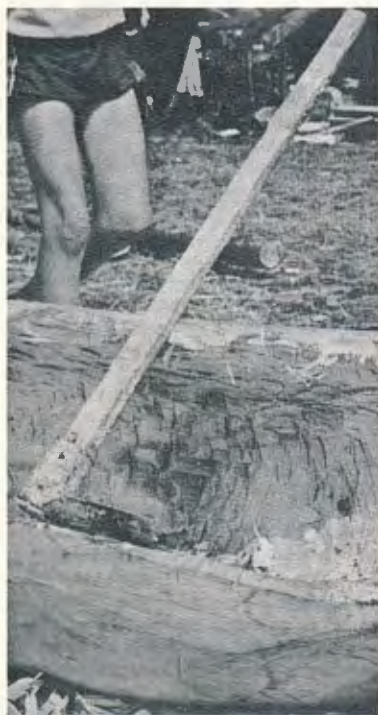
Her ses det vigtigste redskab i udhulningen, den runde skarøkse, som skal specialmedes. Udhulningen af stammen er endnu ikke tilendebragt
